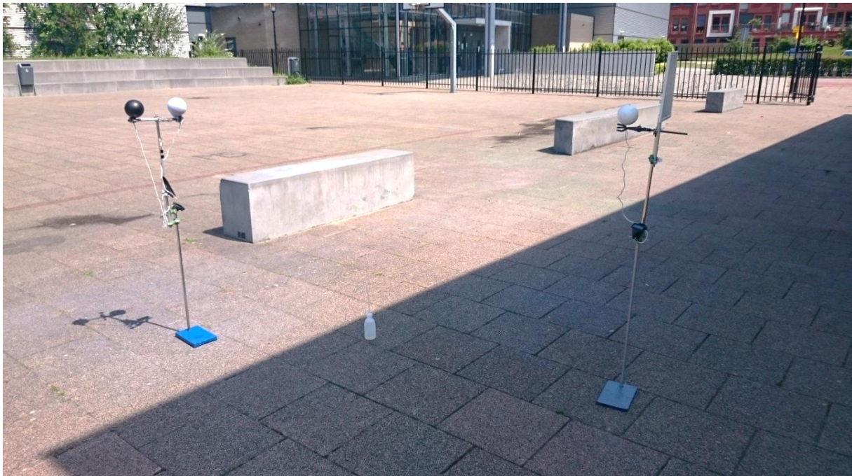
Foto 2 De meetopstelling met 3 bollen v.l.n.r. ( zwarteboltemperatuur, natteboltemperatuur, en witteboltemperatuur)
