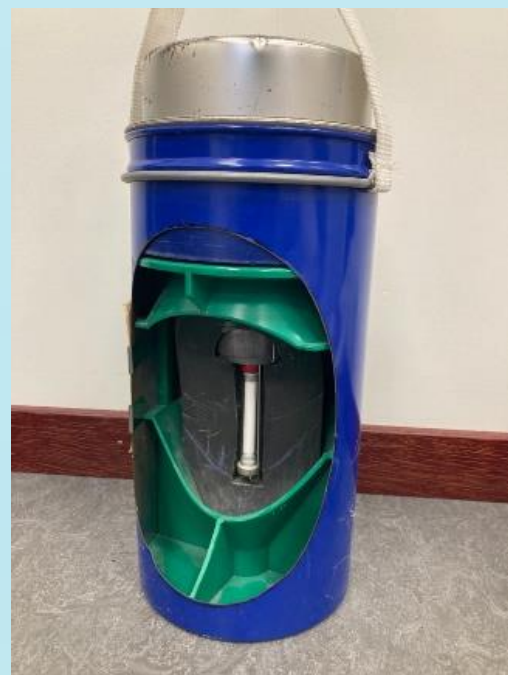
Figuur 5: Een model van een technetiumkoe. In het midden zit een buisje met het radioactieve materiaal. Daar omheen zit lood ter bescherming.
