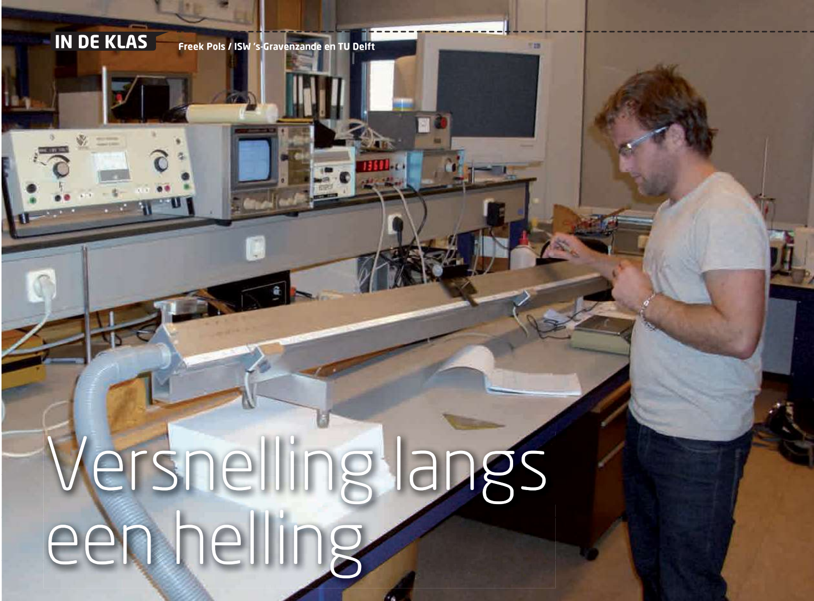
Figuur 1. De opstelling met de baan onder een hoek.
