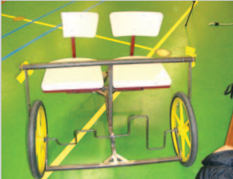
Foto 1. Tandemdriewieler met twee wielen voor (winnend prototype 2007/2008)
