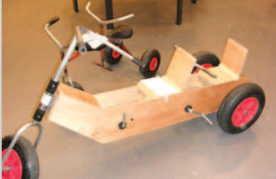
Foto 4: Houten tandemdriewieler met aandrijfriem (finalist 2008/2009)
