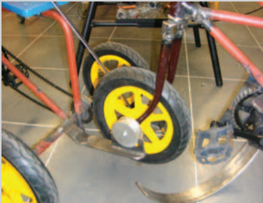
Foto 5: Tandemdriewieler die ontkoppeld kan worden (finalist 2008/2009)
