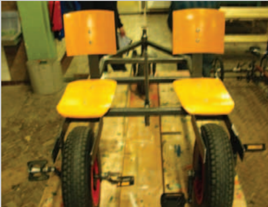
Foto 3: Tandemdriewieler met twee wielen voor en stuurhendel (winnend prototype 2008/2009)
