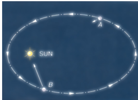
Figuur 3.7: De verandering van de snelheid (2e wet van Kepler) verklaard door Newton.
