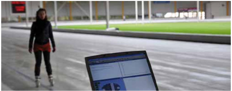
Met een afstandssensor kan meteen een x,t -grafiek gemaakt worden.
