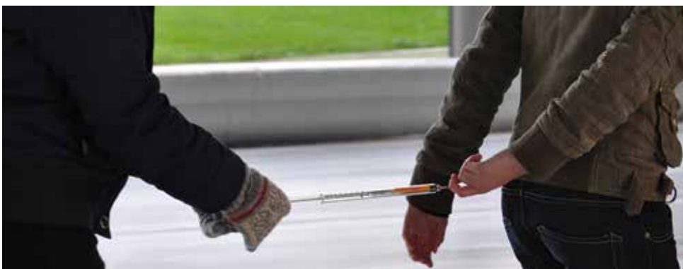
De wrijvingskracht kan afgelezen worden op de veerunster.
