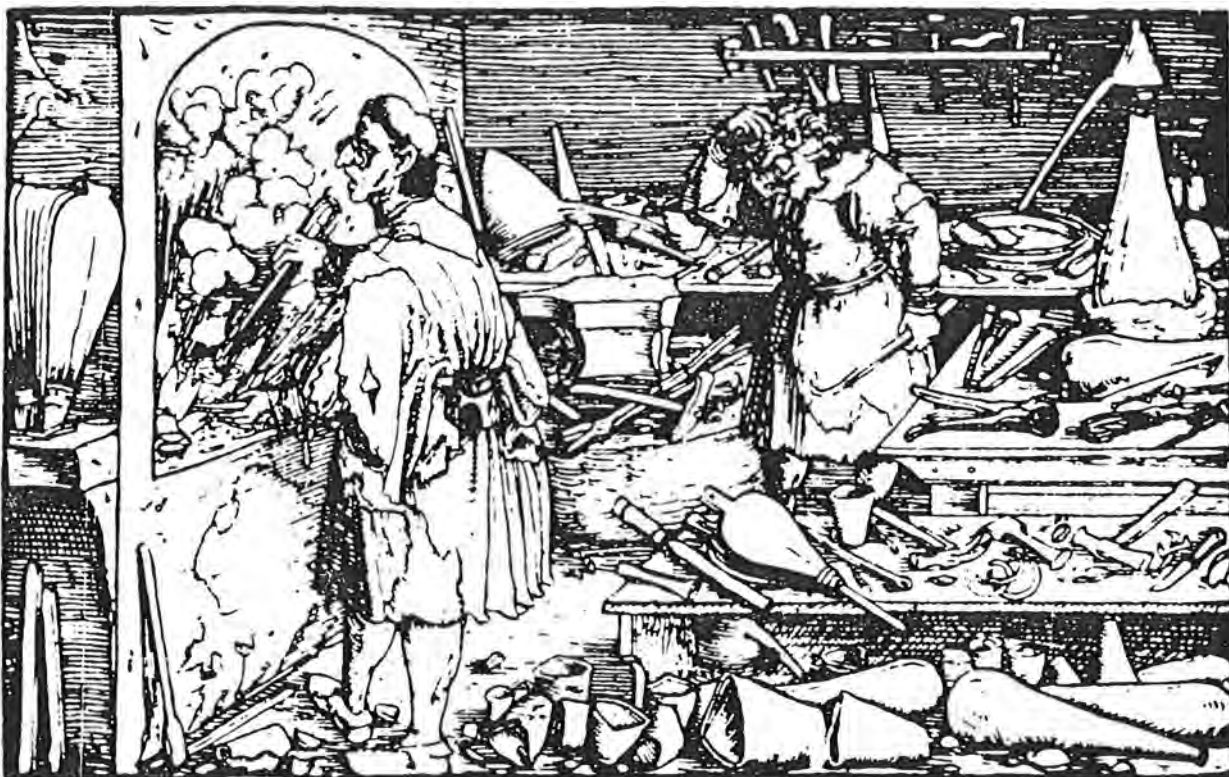
Afbeelding 1. Alchemistisch laboratorium (houtsneede uit de Petrarca-meester, circa 1520). Op de voorgrond driekantige smeltkroezen en fiolen. Rechts op de achtergrond een destilleerkolf. Links achter de alchemist een liggende alembiek (destillatie-opzet).
