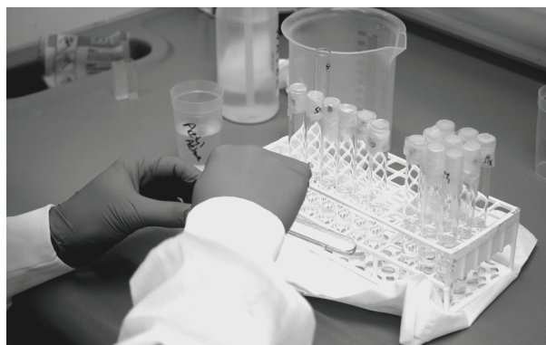
fig. 1 Prepareren van verschillende bekende concentraties als voorbereiding op het maken van een kalibratielijijn.
