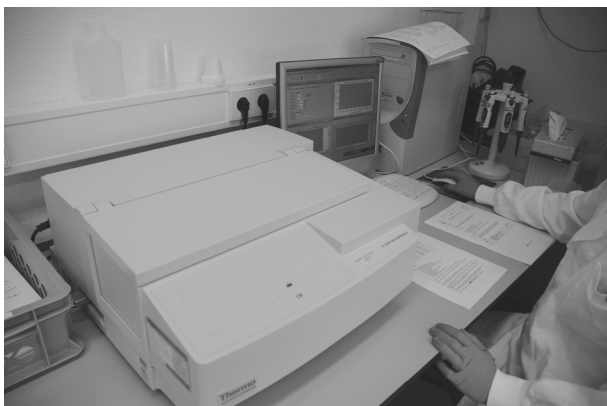
fig. 3 Meten van de verschillende bekende concentraties met een spectrofotometer en daaraan gekoppeld computerprogramma.
