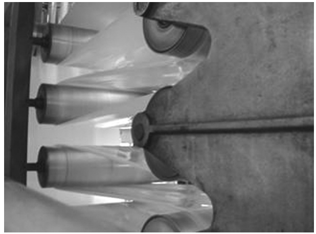
fig. 4 De plek in het productieproces waar de spanning op de slang (hol maar plat) erg variabel was
