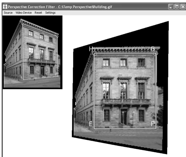
fig. 1 Rectificatie van de voorkant van een gebouw
