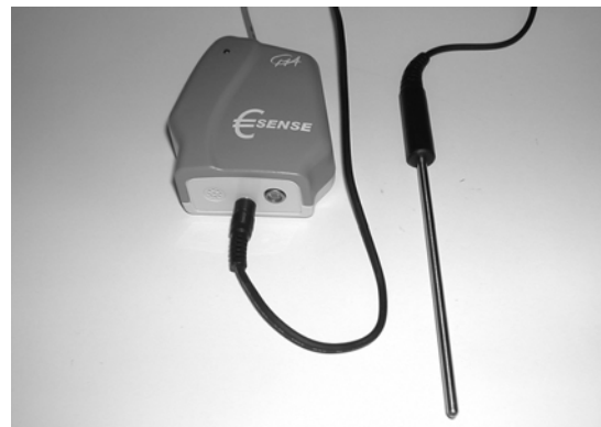
figuur 4: Eurosense sensor voor het meten van temperatuur, lichthoeveelheid en geluidsvolume
