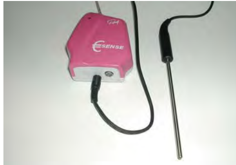
figuur 22: de Eurosense sensor voor het meten van temperatuur, geluidsvolume en hoeveelheid licht
