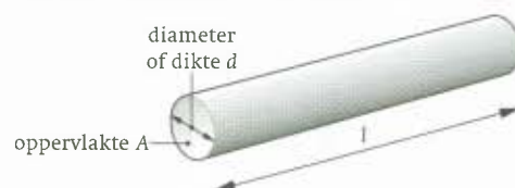
FIG. 10 De doorsnede van een draad.
