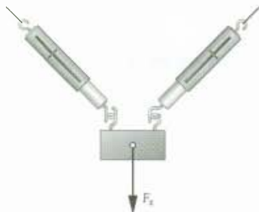
FIG. 13 De krachtmeters werken onder een hoek.
