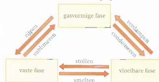
FIG. 27 Het schema van de fase-overgangen.
