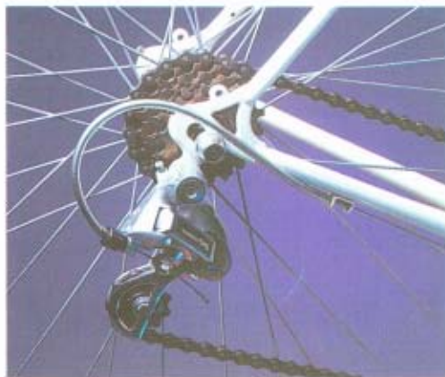
FIG. 22 De overbrenging bij een fiets met derailleur.
