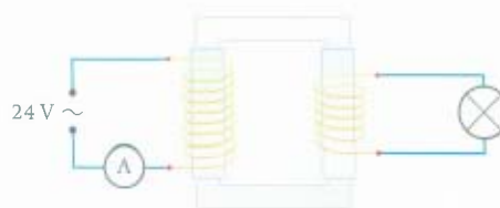
FIG. 65 Een lampje is aangesloten op een transformator.
