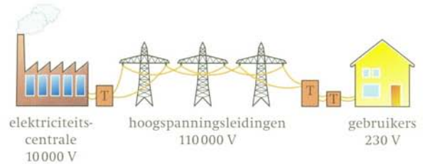
FIG. 23 Schema van het transport van elektriciteit.
