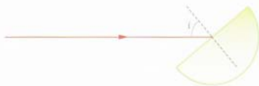
FIG. 50 Een lichtstraal valt op het midden van de rechte zijde van een half-cilindrische lens.
