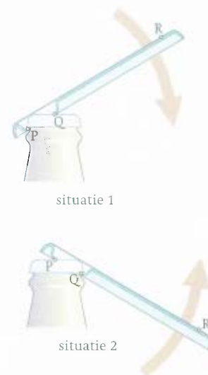
FIG. 38 Twee manieren om een flesopener te gebruiken.
