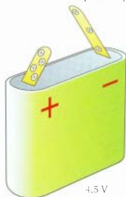
FIG. 53 Een batterij is een spanningsbron.
