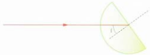
FIG. 51 Een lichtstraal verlaat een half-cilindrische lens.
