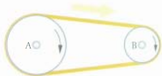
FIG. 33 Een snaaroverbrenging.
