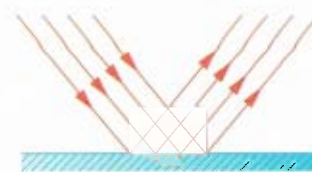
FIG. 2 De lichtstralen van een evenwijdige bundel worden in dezelfde richting teruggekaatst.
