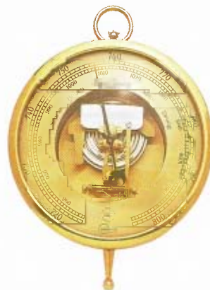
FIG. 30 Een barometer meet de luchtdruk.
