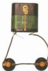
FIG. 6 Een serieschakeling van twee lampjes.
