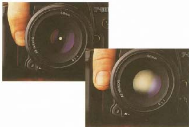
FIG. 27 Een diafragma. Grote opening, veel licht; kleine opening, weinig licht.
