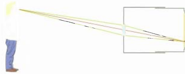
FIG. 13 Het beeld bij een fototoestel met lens.
