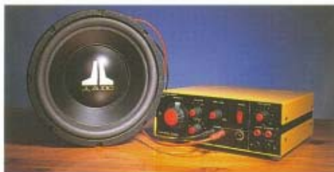
FIG. 52 Een trillende conus veroorzaakt trillende lucht.
