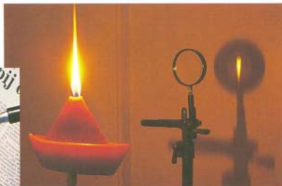
FIG. 3 Afbeelden met een lens. Het beeld staat op z'n kop.
