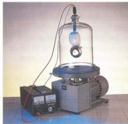
FIG. 11 Een rinkelende bel onder een vacuümsolp.
