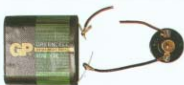
FIG. 1 Het lampje brandt alleen als de kring gesloten is.
