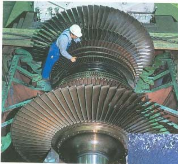
FIG. 13 Een stoomturbine in een elektriciteitscentrale.
