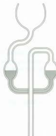
FIG. 4 Een waterslot.
