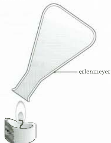
FIG. 5 Het aantonen van een verbrandingsproduct bij de verbranding van kaarsvet.
