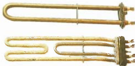
FIG. 19 Een schoon verwarmingselement en een verwarmingselement met kalkafzetting.
