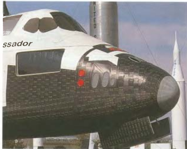
FIG. 17 De space shuttle heeft een beschermende keramische laag aan de onderkant.
