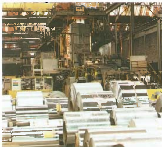
FIG. 34 Blik: dun gewalst staal met een heel dun laagje tin.
