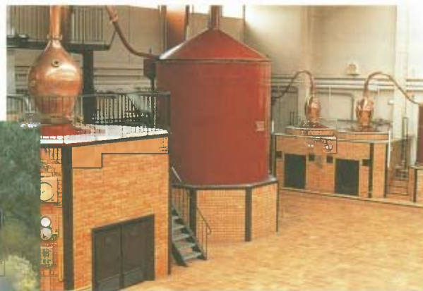
FIG. 18 Destillatie van wijn tot cognac.
