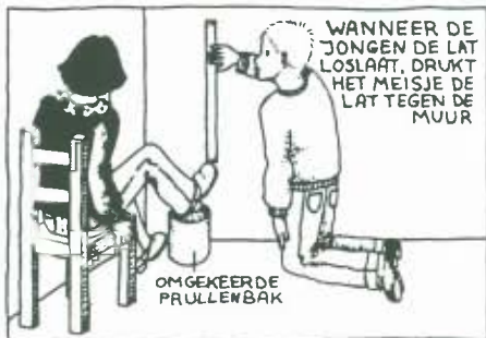
Reactietijd-meting met een vallende schaalverdeling.
