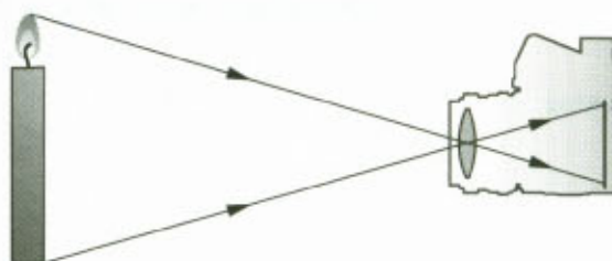
FIG. 12 Een schematische tekening van de beeldvorming bij een fotocamera.
