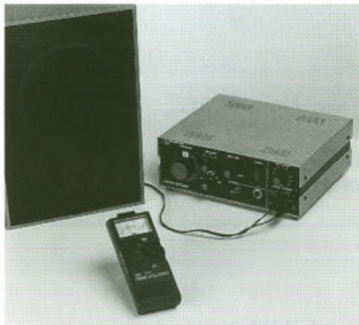
FIG. 21 Opstelling voor het meten van de geluidsstrekte.
