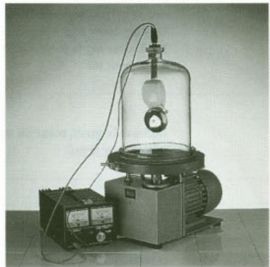
FIG. 10 Een elektrische bel onder een vacuümstolp.
