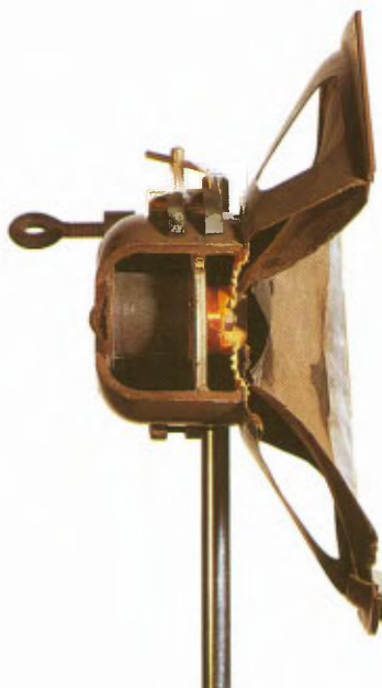
FIG. 32 Een doorsnede van een luidspreker.
