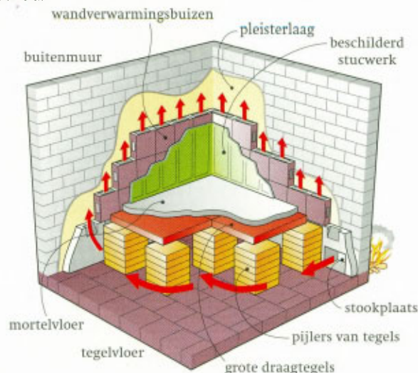
FIG. 1 Vloer- en wandverwarming van een Romeinse villa in de oudheid.
