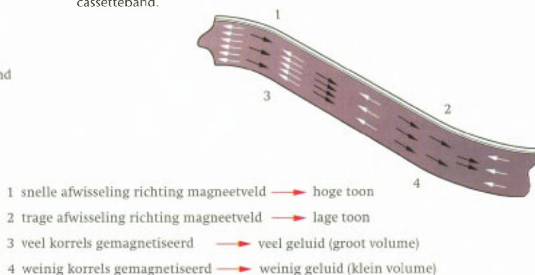
FIG. 34 Schematische voorstelling van een stukje bespeelde cassetteband.
