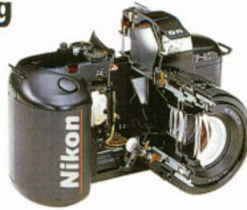
FIG. 35 Foto van een opengewerkt fototoestel.
