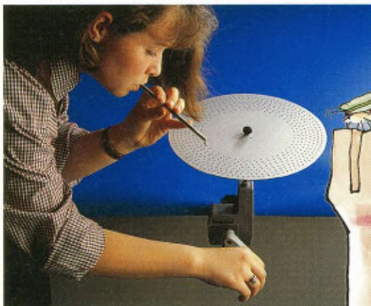
FIG. 98 Een sirene; op de rand van de schijf zitten 44 gaatjes.
