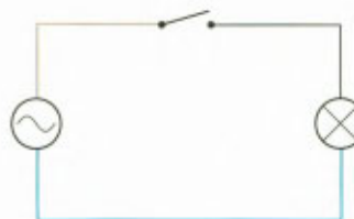
FIG. 7 Schakeling met kleurcode.
