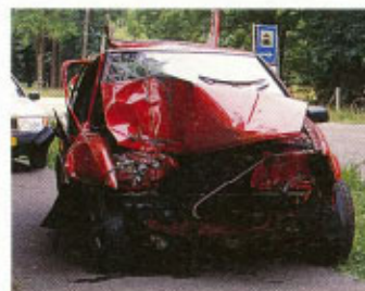
FIG. 31 De neus van moderne auto's wordt met opzet niet sterk gemaakt. Bij een botsing 'kreukt' de neus in elkaar. De rest van de auto komt dan geleidelijker tot stilstand, de passagiers met een veiligheidsriem om dus ook. De remweg is nu immers groter.
