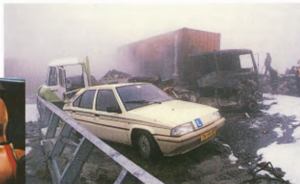
FIG. 35 De vangrail op de autosnelweg voorkomt dat auto's bij ongelukken op de verkeerde weghelft komen. Maar de vangrail is ook zó gemaakt dat hij bij een botsing meebuigt. Zo wordt de remweg vergroot en de remkracht verkleind.
