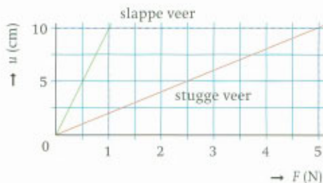
FIG. 12 Uitrekking van een slappe veer en van een stugge veer.
