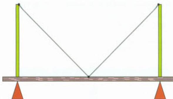
FIG. 74 De kabels houden het midden van de plank omhoog. De plank blijft hierdoor recht liggen.
