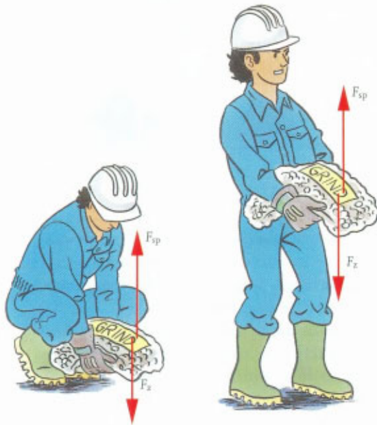
FIG. 5a Optillen: F_{sp} is groter dan F_z
