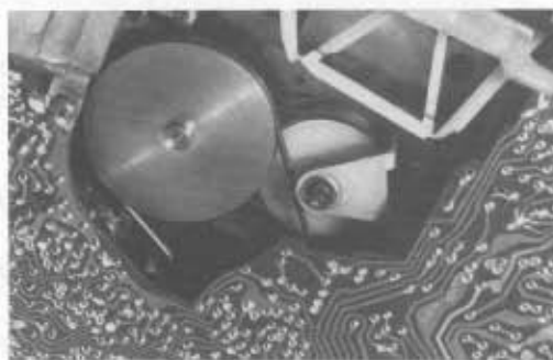
fig. 24 De aandrijving van een cas- setterecorder.
