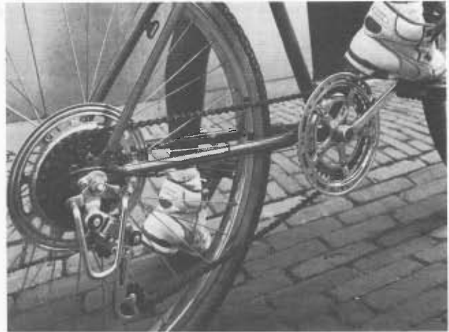
fig. 29 De overbrenging bij een fiets met een derailleur.
