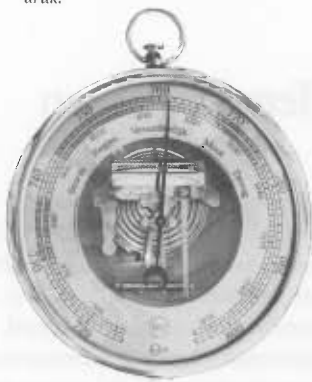
fig. 30 Een barometer meet de luchtdruk.
