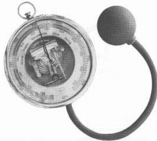
fig. 22 De metaalbarometer van Vidi.
