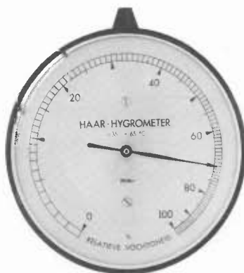
fig. 48 Een haarhygrometer.
