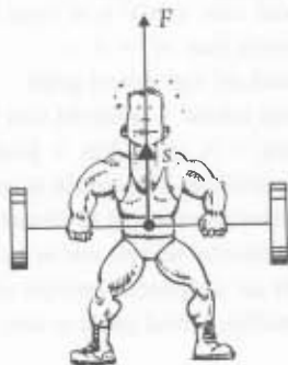
fig. 5 Kracht en verplaatsing hebben dezelfde richting: de arbeid is positief.
