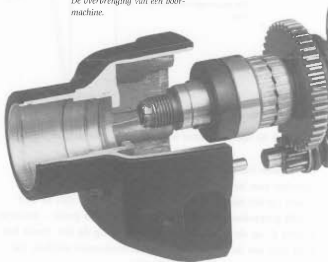
fig. 23 De overbrenging van een boor- machine.
