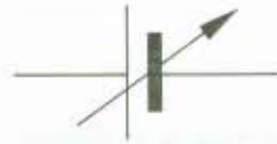
fig. 2 Symbool voor een regelbare spanningsbron.
