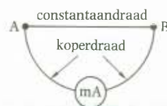
fig. 5 Hoe maak je een thermo-element?
