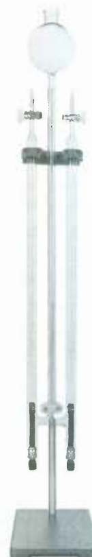
fig. 3 Met dit apparaat kunnen we water ontleden in waterstof en zuurstof. Daarbij wordt ieder watermolekuul opgedeeld in drie atomen: twee waterstofatomen en één zuurstofatoom.
