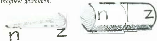
fig. 11 Spijker bij een staafmagneet. De kop van de spijker wordt zuidpool, de punt noordpool. De zuidpool van de spijker wordt naar de noordpool van de magneet getrokken.
