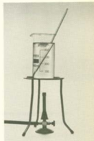
fig. 15 Bekerglas met ijs en water verwarmen boven een brander met driepoot en gaasje.
