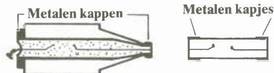
Zekeringen nadat ze zijn doorgeslagen
