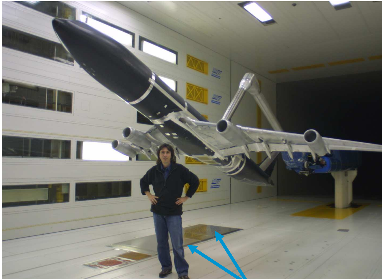
Arrays op de vloer
