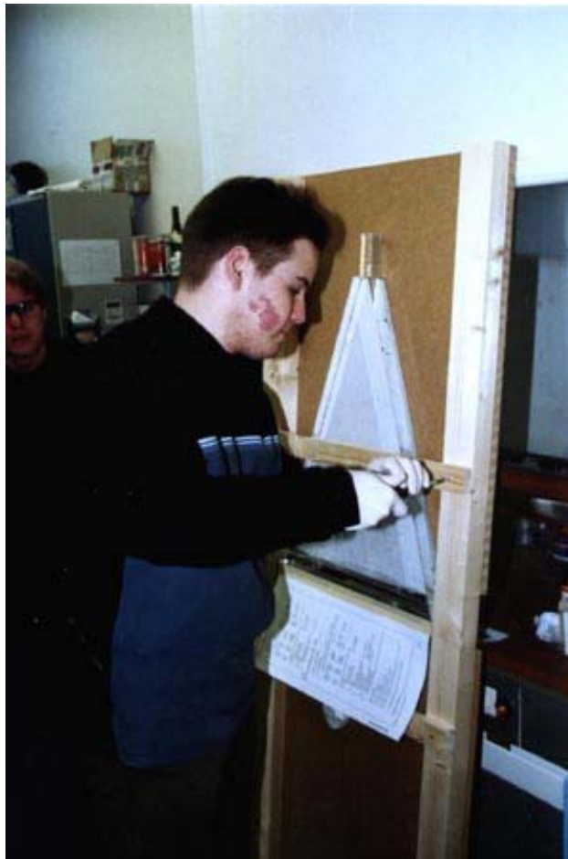
Een leerling uit Nijmegen plakt een scintillator
