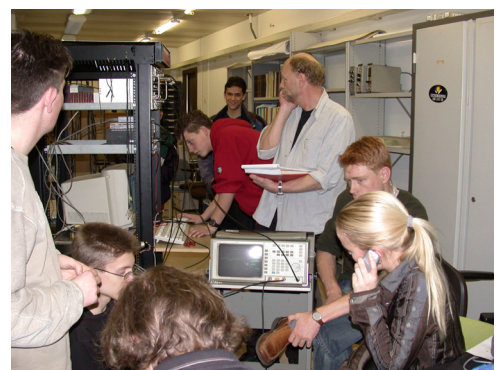
Figuur 4 – Ruwe afregeling van de PMT-hoogspanning met behulp van het signaal op het scoopscherm. Op de achtergrond de apparatuur voor meting van de detectorefficiëntie.
