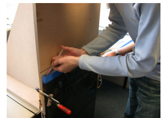
Lijm aanbrengen voor het lijmen van de lichtgeleider op de ingepakte scintillatorplaat.
