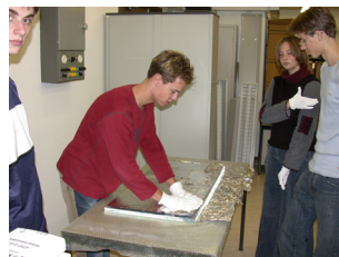
Scintillatorplaat inpakken in aluminiumfolie – en daarna in zwart landbouwplastic.
