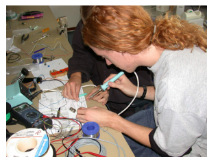
Solderen van de PMT-aansluiting met hulp van René Barthel (medewerker SAP).
