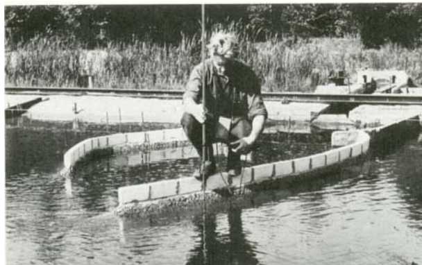
Figuur 1 - Een schaalmodel van een havenmonding.
